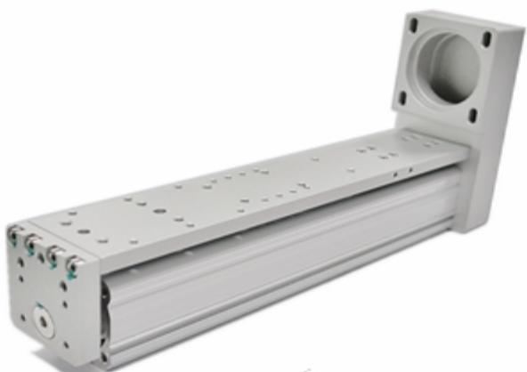
作为机械行业从业者, 电缸相信大家都不陌生。它可以简化设计者工作量, 在有限的空间里实现更多的功能, 同时美观、可靠性强。电缸的构成、分类齿形带式电缸。这是\*\*常见的一种电缸, 电缸通常由自支撑结构型材、直线导轨、齿形带、齿形带轮、防尘带、滑架、及若干其他附件组成。精度适中、行程可选范围广, 使用范围很\*\*\*。滚珠丝杠式电缸。这种电缸由自支撑结构型材、直线导轨、滚珠丝杠、防尘带、滑架、及其他若干附件组成。区别于齿形带传动, 滚珠丝杠传动精度更高, 安装精度、成本各方面也更高。通常应用在精度要求很高的场合。齿轮齿条式电缸。这种电缸驱动方式为齿轮齿条, 可以提供更大的驱动力, 适用于重载场合, 一般来讲, 规格型号都比较大。电缸的驱动方式与性能息息相关, 但如何找到\*\*合适的驱动系统, 为了说明, 将挑选3种不同应用场景。案例1-高性能包装系统生产力、性能和安全: 在包装行业, 速度就是一
